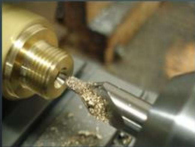
Pembubutan lubang senter pada permukaan ujung benda kerja
