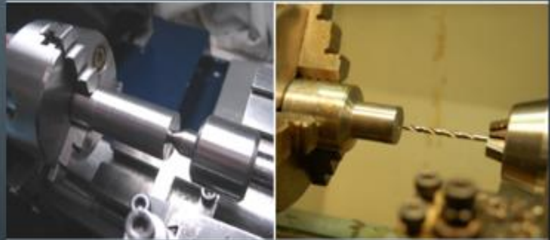
Fungsi lubang senter bor sebagai dudukan senter putar dan pengarah pengeboran
