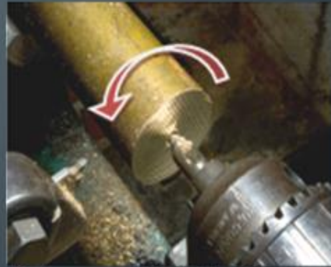
Putaran mesin bubut harus searah jarum jam
