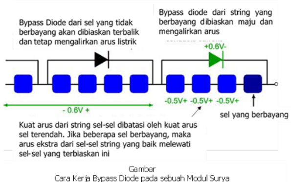
Gambar 1.45 Cara kerja bypass diode pada sebuah modul surya
