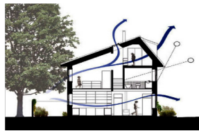
Gambar 1.15 Ventilasi udara harus lancar
