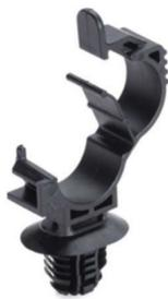
Locking Clamp sangat ideal untuk mengikat kawat dan bundel kabel ke panel. Desain pohon cemara yang unik memegang erat dalam ukuran lubang yang telah dibor sebelumnya dari 9 × 12 mm hingga 9 × 14 mm.
