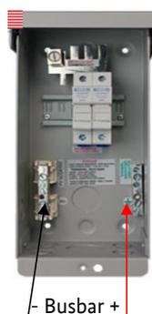
Busbar adalah titik sambungan untuk beberapa string modul fotovoltaik. Perangkat ini membawa beberapa string ke konduktor yang sama, artinya busbar (+) untuk kabel string (+), dan busbar (-) untuk kabel string (-). Busbar DC terbuat dari konduktor tembaga padat dan berlapis timah untuk perlindungan terhadap korosi.
