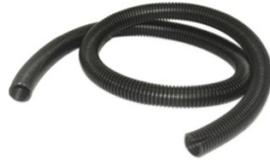
Cable Conduit merupakan selang fleksibel yang dapat disambungkan dengan pipa PVC dengan menggunakan aksesoris. Penyambungan dapat juga menggunakan potongan logam/PVC pendek yang disambung sedemikian rupa sehingga mudah diatur dan lentur. Atau dapat juga membuat pipa lengkung dari pipa PVC yang dipanaskan.
