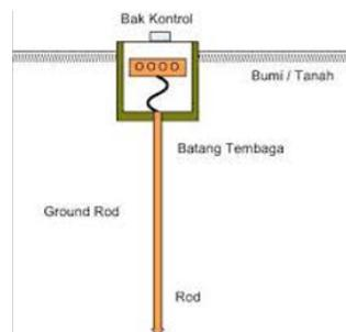
Pada permukaan Atap dibuatkan bak kontrol dimana busbar dipasang dan kepala grounding bar berada. Busbar ini berguna untuk menyambung beberapa kabel pentanahan dari perangkat lainnya.
