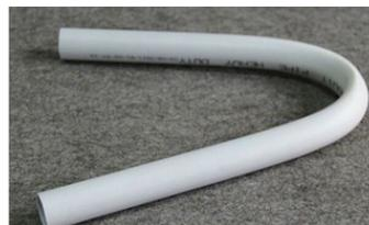
Pipa ini dibuat dari bahan paralon / PVC. Jika dibandingkan dengan pipa union, keuntungan pada pipa PVC adalah lebih ringan, lebih mudah pengerjaannya (dengan pemanasan) dan merupakan bahan isolasi, sehingga tidak akan mengakibatkan hubung singkat antar penghantar.
