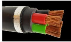
Kabel NYYHY merupakan kabel berinti serabut tembaga dengan 2, 3, 4 atau 5 kabel, berisolasi PVC dengan warna berbeda, kemudian berisolasi PVC lagi dan berselubung luar isolasi PVC hitam.
